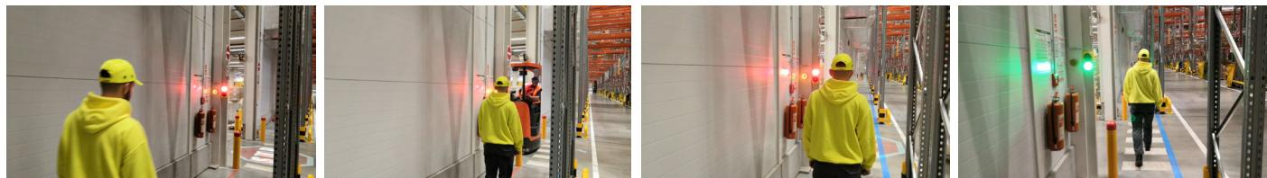
Industrielle Sicherheitssensoren verringern die Wahrscheinlichkeit von Kollisionen zwischen Flurfördertechnik und Fußgängern in Lagern und Produktionsstätten. Das Ton- und Licht-Signalisierungssystem lässt sich an unübersichtlichen Stellen bei Straßenüberquerungen, Ausfahrten von Ladestationen oder Durchfahrten zwischen Hallen einsetzen.
